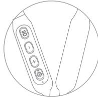
Ⓞ 长按 3 秒开关机;来电短按接听电话,长按拒绝来电;播放时短按暂停,暂停时短按播放;连接中双击断开当前连接,进入新配对模式;配对时双击切换中英文语音提示。
